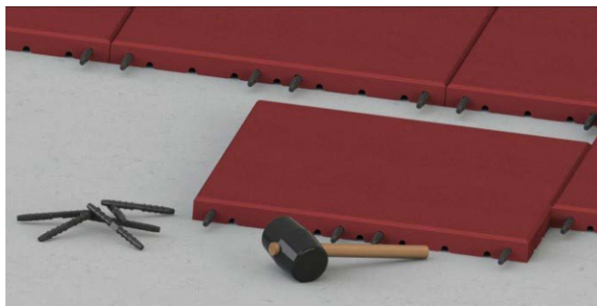
Obr. K2: Pokládka čtvercových dlaždic „na cihličku“
